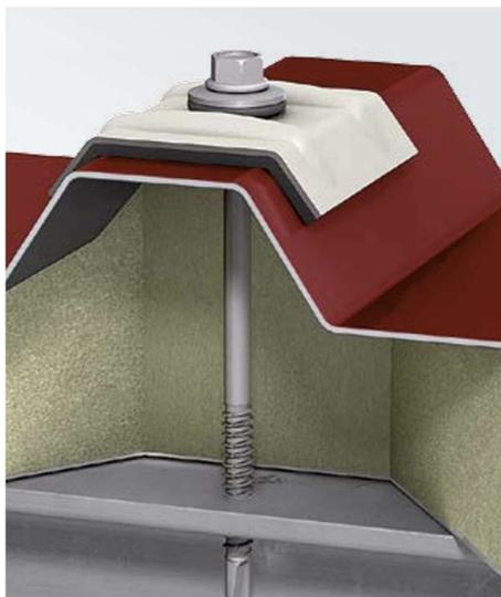
En FACYTEC aseguramos las tejas termoacústicas con tornillos pasantes a la estructura de acero con bajo contenido de carbono, con acabado orgánico resistente a la corrosión, de elevada resistencia a succión y con capelote de aluminio del mismo color de las tejas evitan punzonamiento en caso de succiones.
